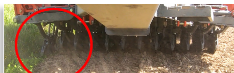
Bilde 2: Styrken til Orions skål er dens geometri og eksepsjonelt brede bevegelsesområde både opp og ned. Dette muliggjør vellykket såfrøplassering selv etter redusert jordbearbeiding.
