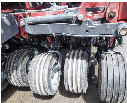
ROMSLIG: Bedre plass mellom dybdehjulene er en av detaljene Hortemo liker ved den nye Super Novaen.
