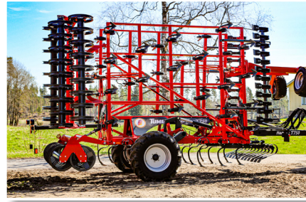
De store transporthjulene med bred sporvidde gir stødig gange selv i høye hastigheter.
