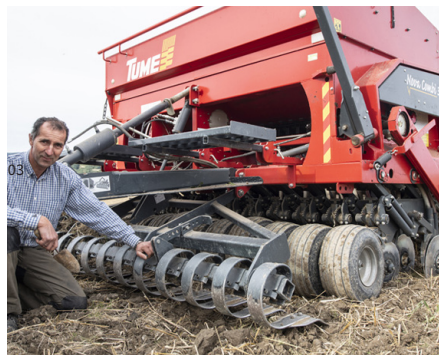
VIKTIG: Gjelsvik mener sloddeplanke er nødvendig for å planere foran hjulene som bestemmer sådybden, men advarer mot å legge den på for hardt.
