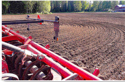
Den standardmonterte U-profilerte dobbeltpakkeren holder stabil harvedybde under alle forhold.
