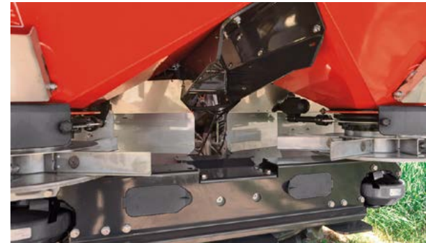
En elektrisk aktuator for å kontrollere påføringshastigheten
