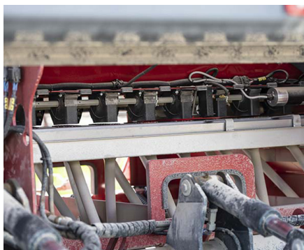
RUSTFRITT: Syrefast stål under utmaterne er en forbedring på nye Super Nova.
