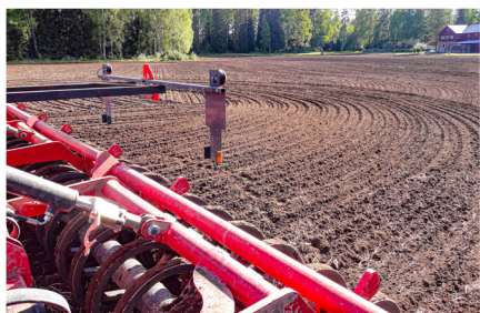
Den standardmonterte U-profilerte dobbeltpakkeren holder stabil harvedybde under alle forhold.
